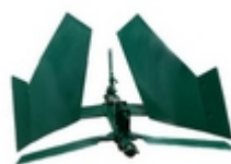
Jednobrazdni okretni plug PJO-180
